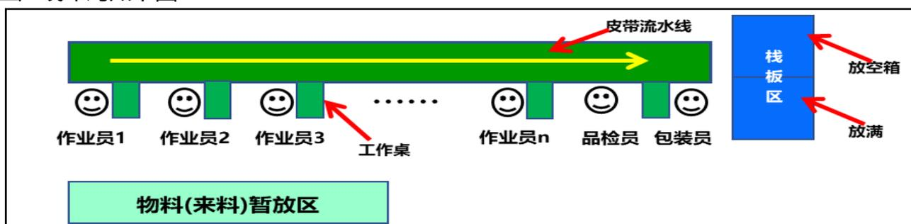
图 1：装配生产线示意图
