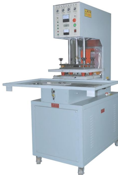
图 4 高周波吸塑包装焊接设备
